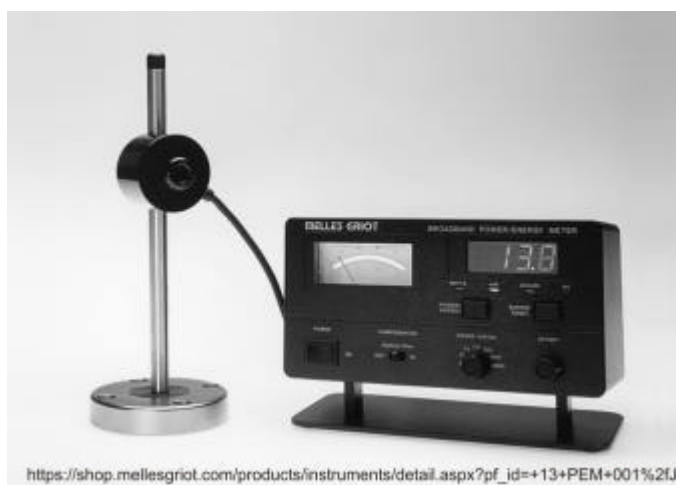
Figura 14 - Equipamento utilizado para a aferição da potência das fontes emissoras.
